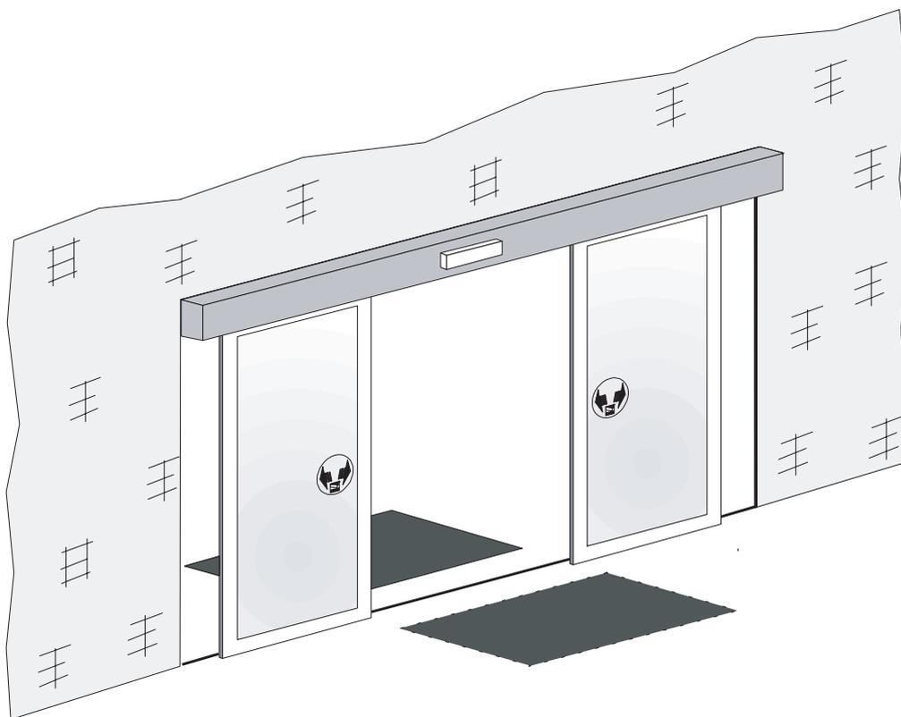
**MP** - устройство управления для автоматических дверей. Процесс установки устройства очень прост - положите чувствительный коврик около двери под любое покрытие (например, ковролин).
