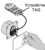
Устройство TAG Для подачи команды управления (например, «Открыть») необходимо поднести к считывателю проксимити карту или пульс дистанционного управления, оснащенный устройством TAG. Для подачи команды «Закрыть» повторите операцию или дождитесь автоматического закрывания (если данная функция включена).
