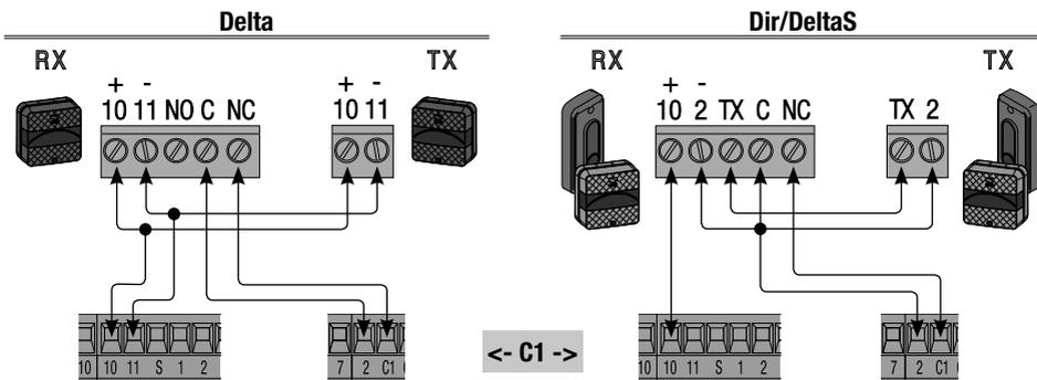
Подключение **функции открывания в режиме закрывания** (Н.З. контакты): для фотоэлементов, чувствительных профилей и других устройств безопасности, соответствующих требованиям стандарта EN 12978. Размыкание контакта во время закрывания ворот приводит к изменению направления движения на противоположное, вплоть до полного открывания.
