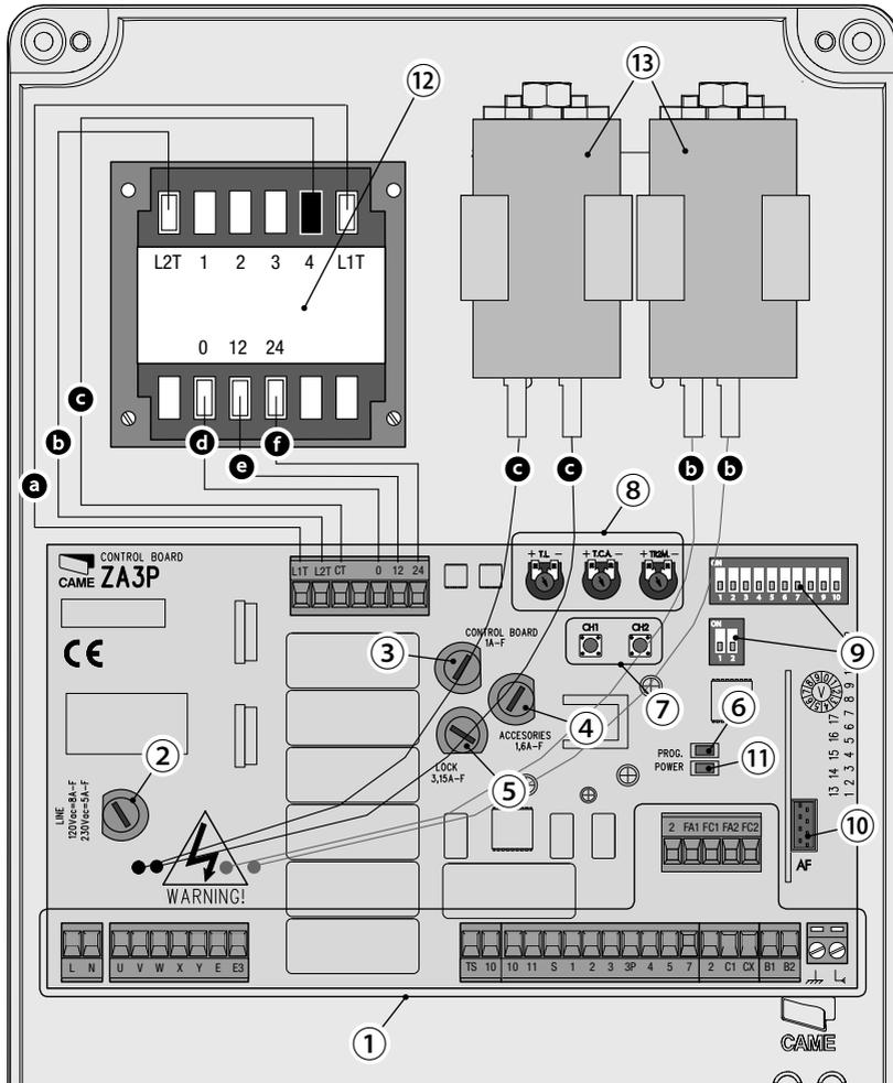
\***13** Конденсаторы входят в комплект привода FROG, 230 В. Подключите их к черным (привод M1) и красным (привод M2) проводам, предусмотренным на плате блока управления; при подключении приводов Ati, Fast, Femi и Клопо эти провода не используются (конденсаторы расположены внутри приводов).
