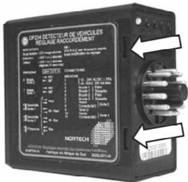
Используя отвертку, слегка надавите на указанные места и осторожно снимите крышку, надавливая на переднюю часть (крышка двигается по направляющим в корпусе).
